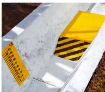
El aforador RBC es una estructura precisa, fácil de construir y de costo relativamente bajo
